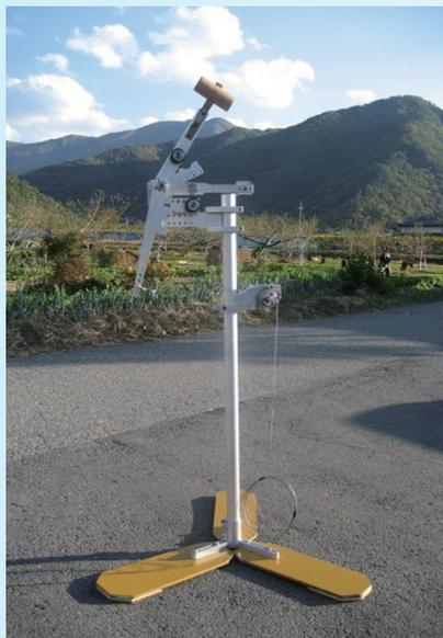
写真⑧地上操作型半鐘叩き装置
